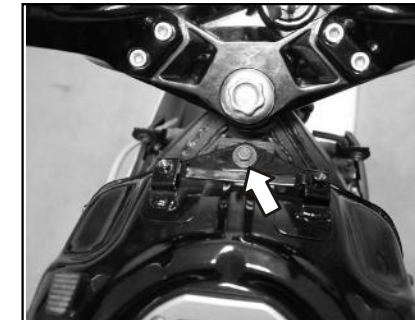
Montaje delantero de tanque
